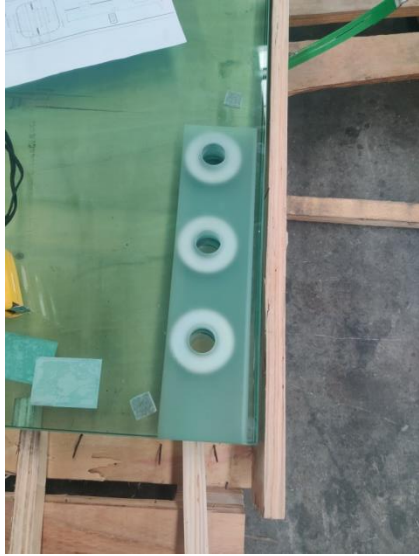
(a) 开孔周围做磨砂处理后的钢化玻璃试件
